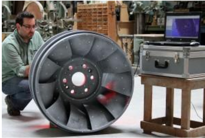
Percival 正在扫描混流式转轮铸件
